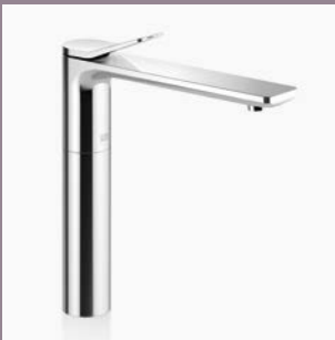
33 537 845 Single-lever basin mixer without pop-up waste, 215 mm projection Miscelatore monocomando lavabo senza piletta, sporgenza 215 mm Monomando de lavabo sin válvula automática, saliente 215 mm [5,3 l/min.] [USA: 5.3 l/min. / 1.4 gpm]
